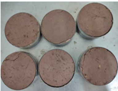
Hình 2.2 - Mẫu đất thí nghiệm bị nứt, co ngót
